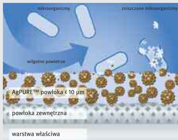
Schemat działania aktywnego srebra AgPure™ na mikroby
